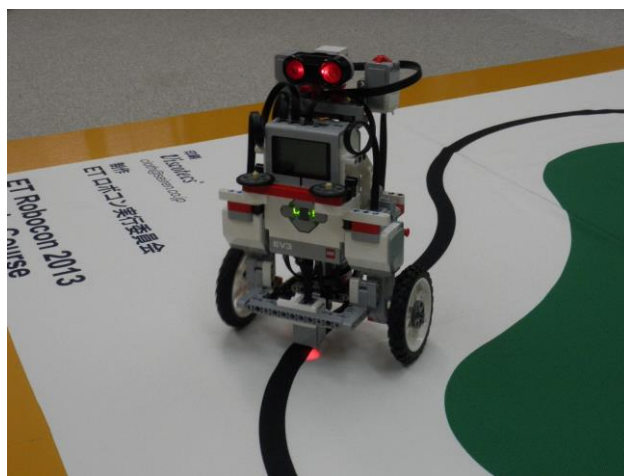
車輪型倒立振り子ロボット(ETロボコン)
